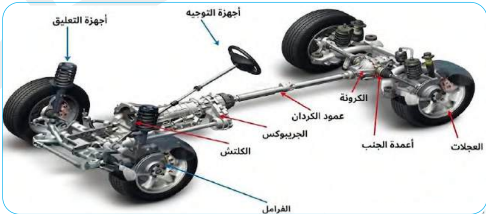
شكل رقم (٥): أجهزة نقل الحركة، التعليق والتوجيه.
